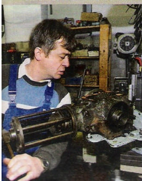
DER RESTAURATOR In seiner Freizeit baut er für Kunden Teile von Skoda-Oldtimern neu auf – hier eine Felicia-Hinterachse
