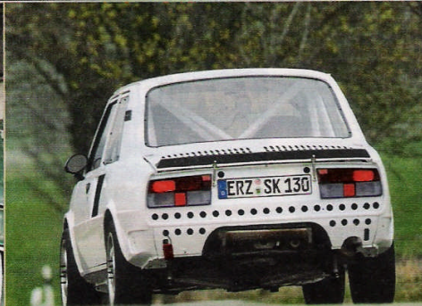
DIE DIÄT Der Rallye-Skoda musste abspecken. Dazu wurde sogar das Heck durchlöchert
